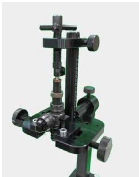
Установка в струбцине насос-форсунки AUDI / VW 1.9
