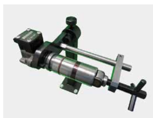
Установка в струбцине насосной секции MB ACTROS
