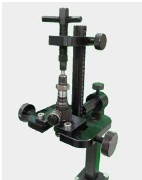
Установка в струбцине насос-форсунки SCANIA Ч-образной
