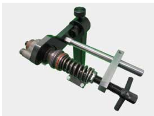
Установка в струбцине насосной секции Delphi 082240354
