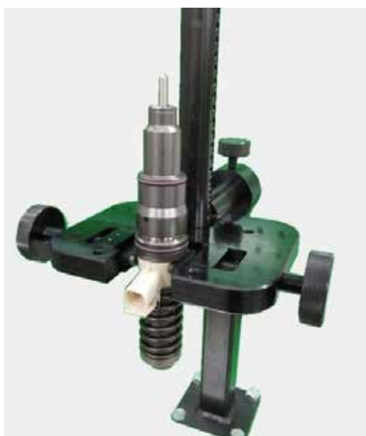
Установка в струбцине насос-форсунки VOLVO Delphi 2x и 4x контактные
