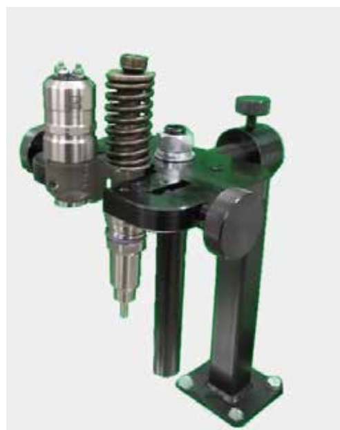
Установка в струбцине насос-форсунки SCANIA Ч-образной
